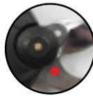
Orificio para lubricación de la cuchilla
