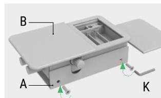
**1.** Séparez la plaque base (A) du corps du verrou (B) en desserrant les vis à l'aide de la clé Allen fournie.
