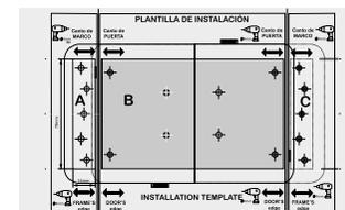
**2A.** Placez le gabarit de pose à l'endroit choisi et marquez sur la porte au feutre les trous qui correspondent au corps du verrou (indiqué par la lettre B sur le gabarit) et à la pièce du logement des boulons (indiqué par les lettres A ou C, selon le côté sur lequel il est installé).
