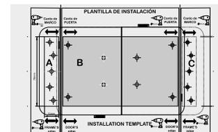
**2A.** Posizionare la dima di montaggio nella posizione prescelta e segnare con un pennarello i fori corrispondenti al corpo della serratura (contrassegnato con la lettera B sulla dima) e alla parte di alloggiamento dei nottolini (contrassegnata con le lettere A o C, a seconda del lato su cui viene installata).
