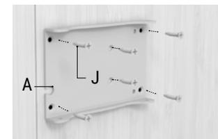
**4.** Fissare la piastra base (A) alla porta utilizzando le viti (J) in dotazione.
