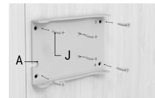
**4.** Befestigen Sie die Basisplatte (A) mit den mitgelieferten Schrauben (J) an der Tür.
