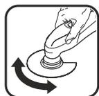
Trabaje ejerciendo una presión reducida uniforme para lograr un buen rendimiento en el trabajo y evitar que se bloquee el útil.
